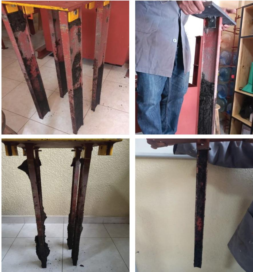
Figura 26. Fotografías de suelo adherido al pilote al extraerlo después de la prueba de carga a tensión.
