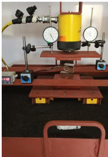
Figura 11. Prueba de compresión axial al grupo de pilotes W24x55.
