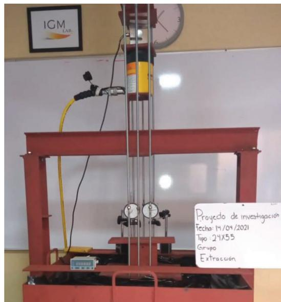
Figura 19. Prueba de tensión axial al grupo de pilotes W24x55
