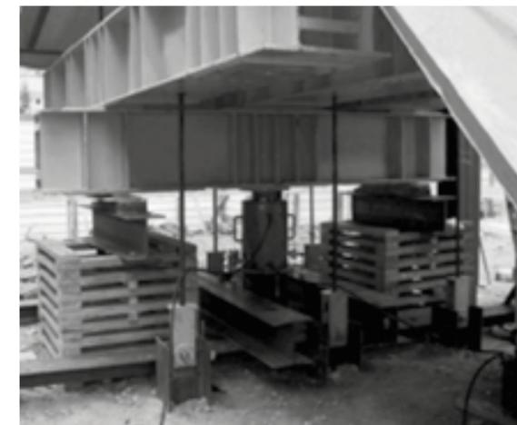
Fotografía 11. Prueba de Carga Estática.
