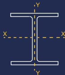
El acero de los perfiles IR es producido de acuerdo con la especificación **ASTM A992 y ASTM A572 G50**
