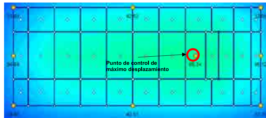
Figura 7. Asentamientos en la losa de la estructura a largo plazo a 5 años.
