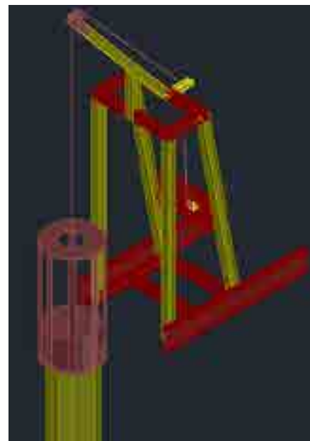
Figura 17. Marco para hincado de viguetas.
