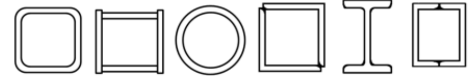
Figura 3. Sección transversal de contravientos
