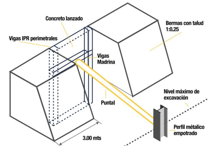
b) A continuación se procederá al habilitado y colocación del primer nivel de viga madrina IR colocando concreto lanzado  $f'c = 150 \text{ kg/cm}^2$  o concreto simple reforzado con malla electrosoldada en los cortes expuesto a la intemperie ubicados entre las vigas verticales, el procedimiento descrito en este inciso se repetirá para cada uno de los niveles de viga madrina hasta alcanzar el nivel terminado de excavación.
