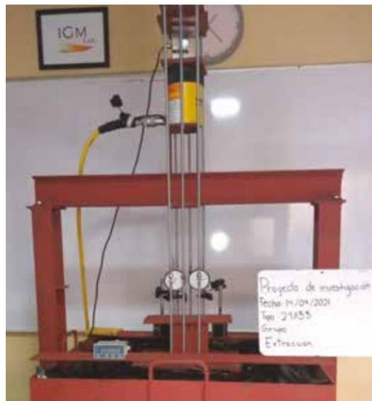
Figura 19. Prueba de tensión axial al grupo de pilotes W24x55
