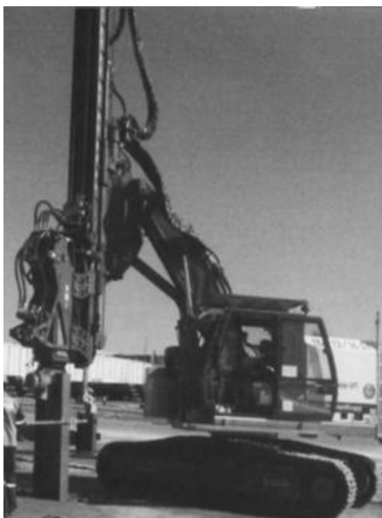
Fotografía 6. Martillo vibratorio eléctrico.
