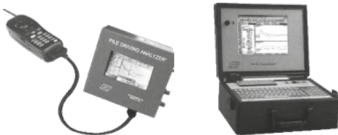
Fotografía 10. Equipamientos PDA para procesamiento de las señales de los transductores acoplados al pilote.
