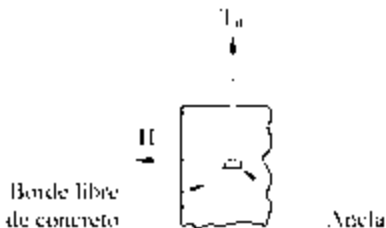
Figura B.4.3 Desprendimiento lateral del borde del concreto en anclas en tensión
