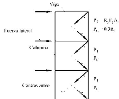
Figura 12.3.15 Fuerza máxima que producen los contraventeos en tensión y en compresión
