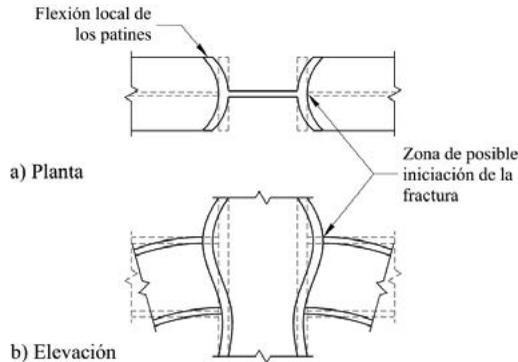
Figura 10.8.1 Deformación de una columna sin atiesadores
