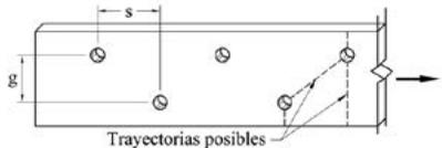
Figura 3.1.1 Distribución de zigzag respecto al eje de la pieza
