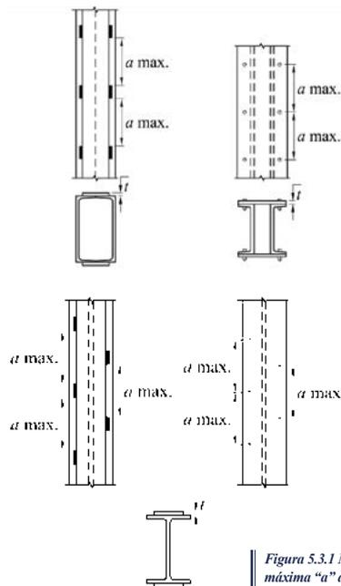
Figura 5.3.1 Miembros armados. Separación máxima "a" de elementos de unión
