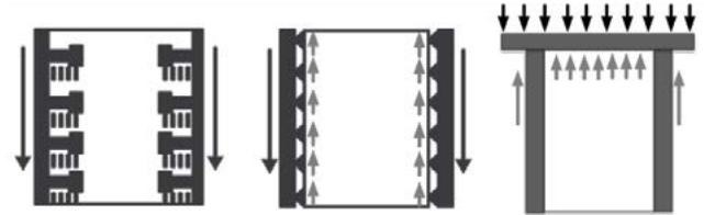
Figura 9.2.2 Mecanismos de resistencia de la carga en la superficie de contacto concreto acero
