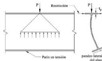
Figura 10.8.5 Pandeo del alma con desplazamiento lateral
