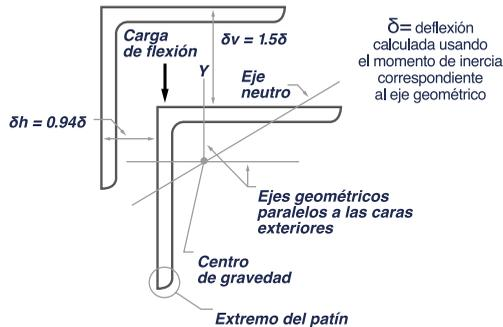
Figura 6.10.2 Ejes geométricos para ángulos de alas iguales
