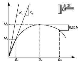
Figura 1.3.2 Definición de las características de rigidez, resistencia y ductilidad en la relación momento-rotación de una conexión semirrígida.
