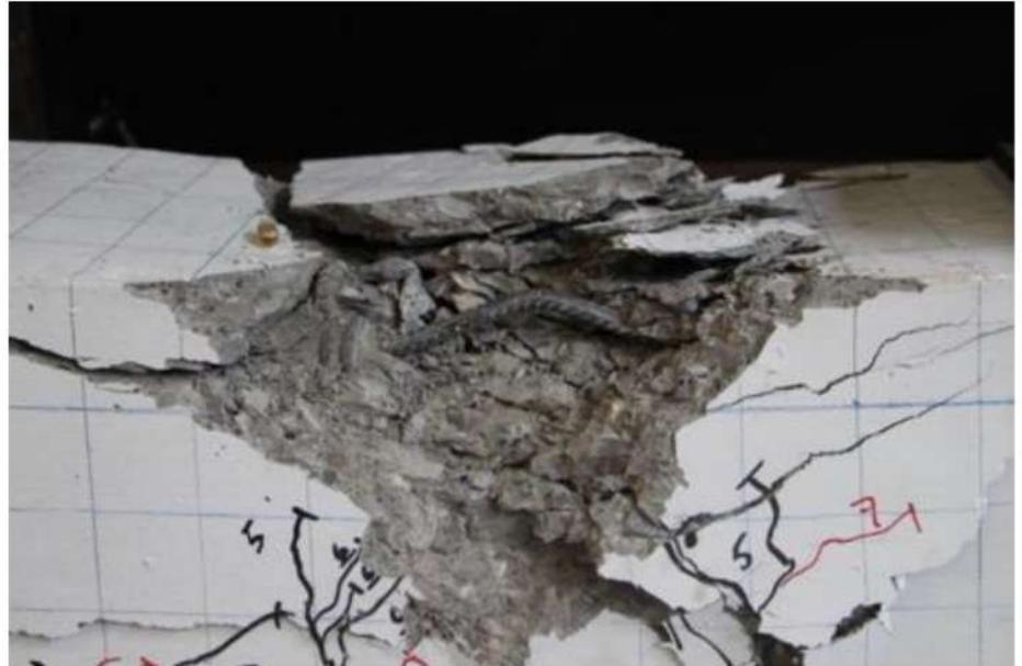
En la figura 31, se muestra la imagen del espécimen V02 al final del experimento. El acero de refuerzo también fluyó y se presentó nuevamente el desconchamiento del concreto.
