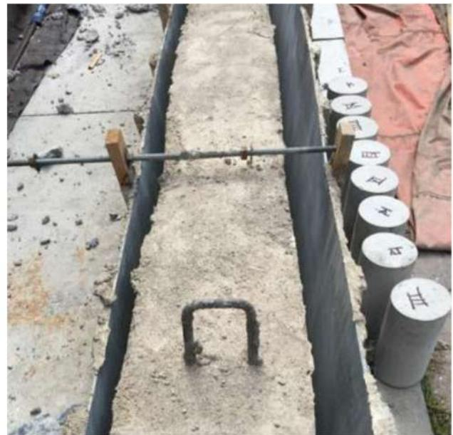
*Figura A8. Cilindros testigo curados igual que los especímenes.*
