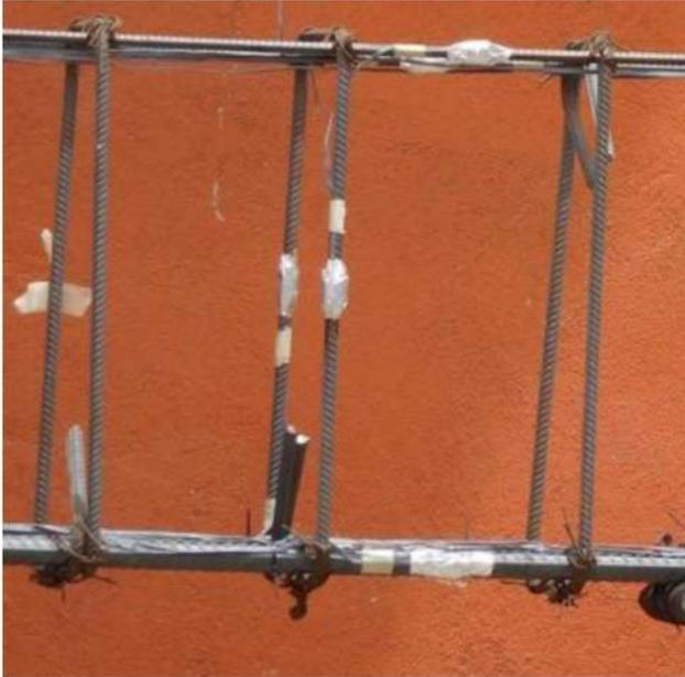
*Figura A5. Strain gages colocados.*
