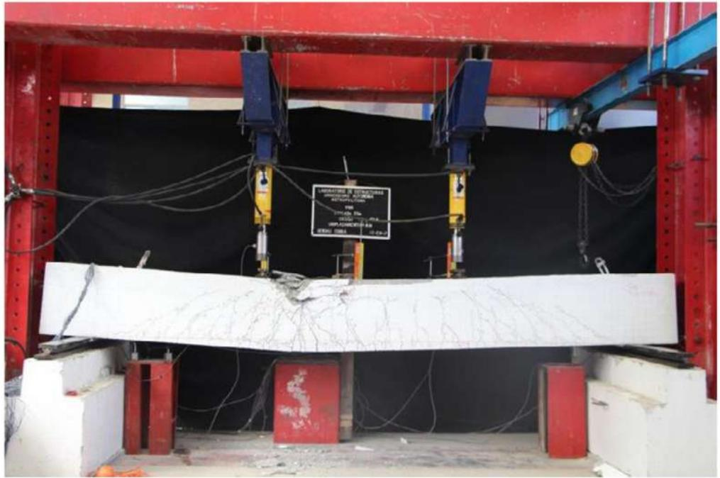
Figura 33. Agrietamiento del espécimen V03 al final del ensaye.
