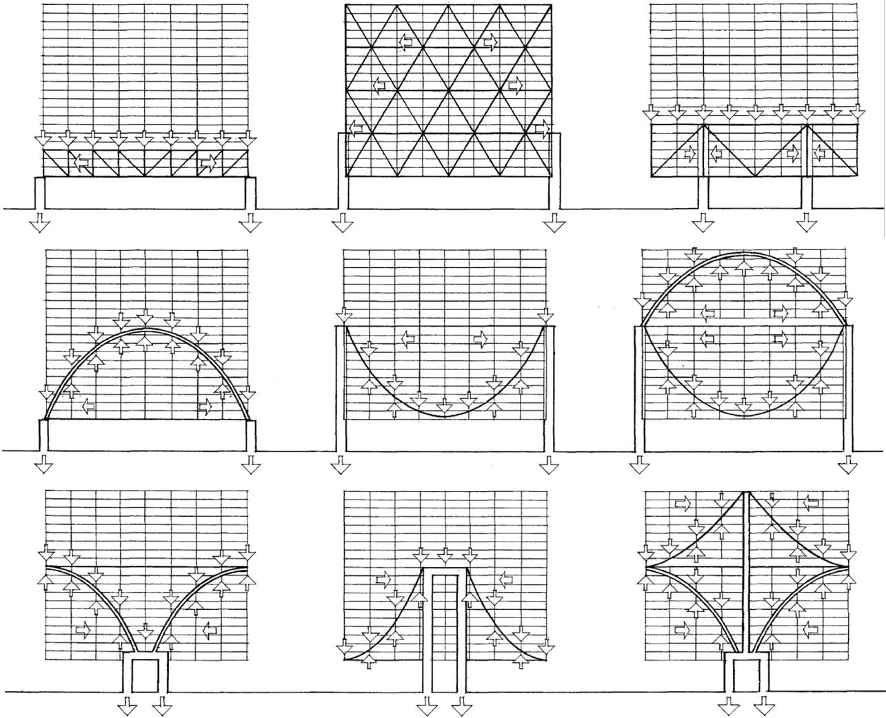
Figura 10. Estructuras típicas de rascacielos puente (Heino Engel, 2003).
