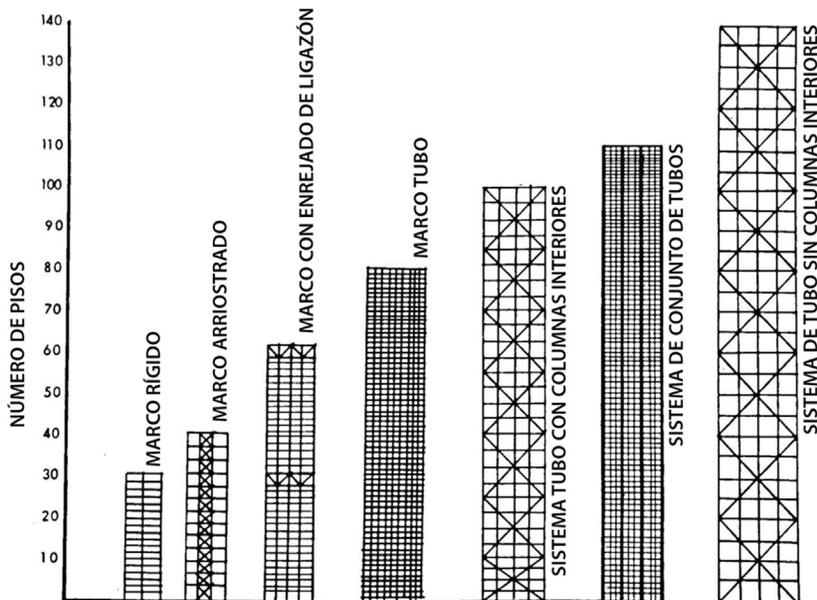
Figura 11. Altura de los edificios con los sistemas estructurales en acero (Fazlur Kahn)
