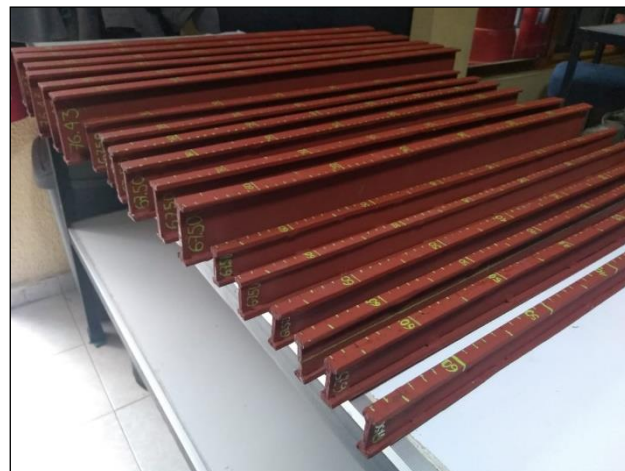
Figura 1. Fotografía de los 18 pilotes a escala tipo IR, marcados a cada 1 cm para llevar un registro de hincado.
