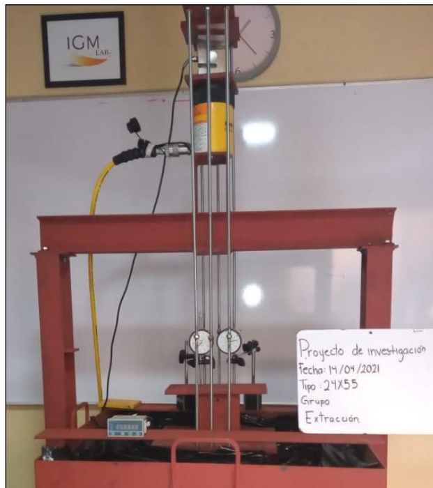
Figura 15. Prueba de tensión axial al grupo de pilotes W24x55.
