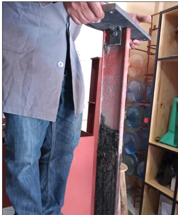
Figura 22. Fotografías de suelo adherido al pilote al extraerlo después de la prueba de carga a tensión.
