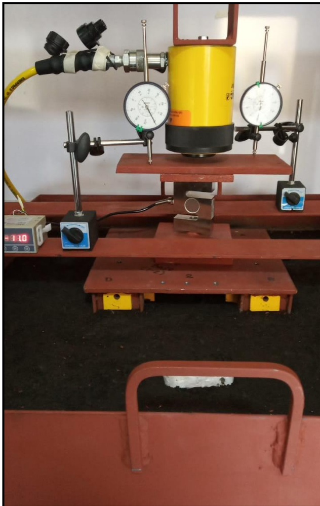
Figura 7. Prueba de compresión axial al grupo de pilotes W24x55.
