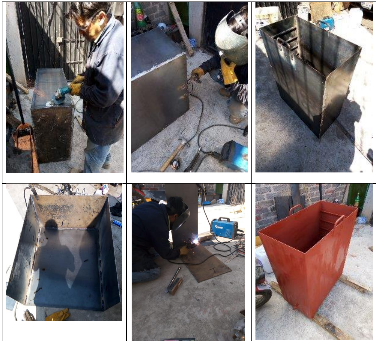
Figura 33. Proceso de fabricación del contenedor para pilotes W10x17.
