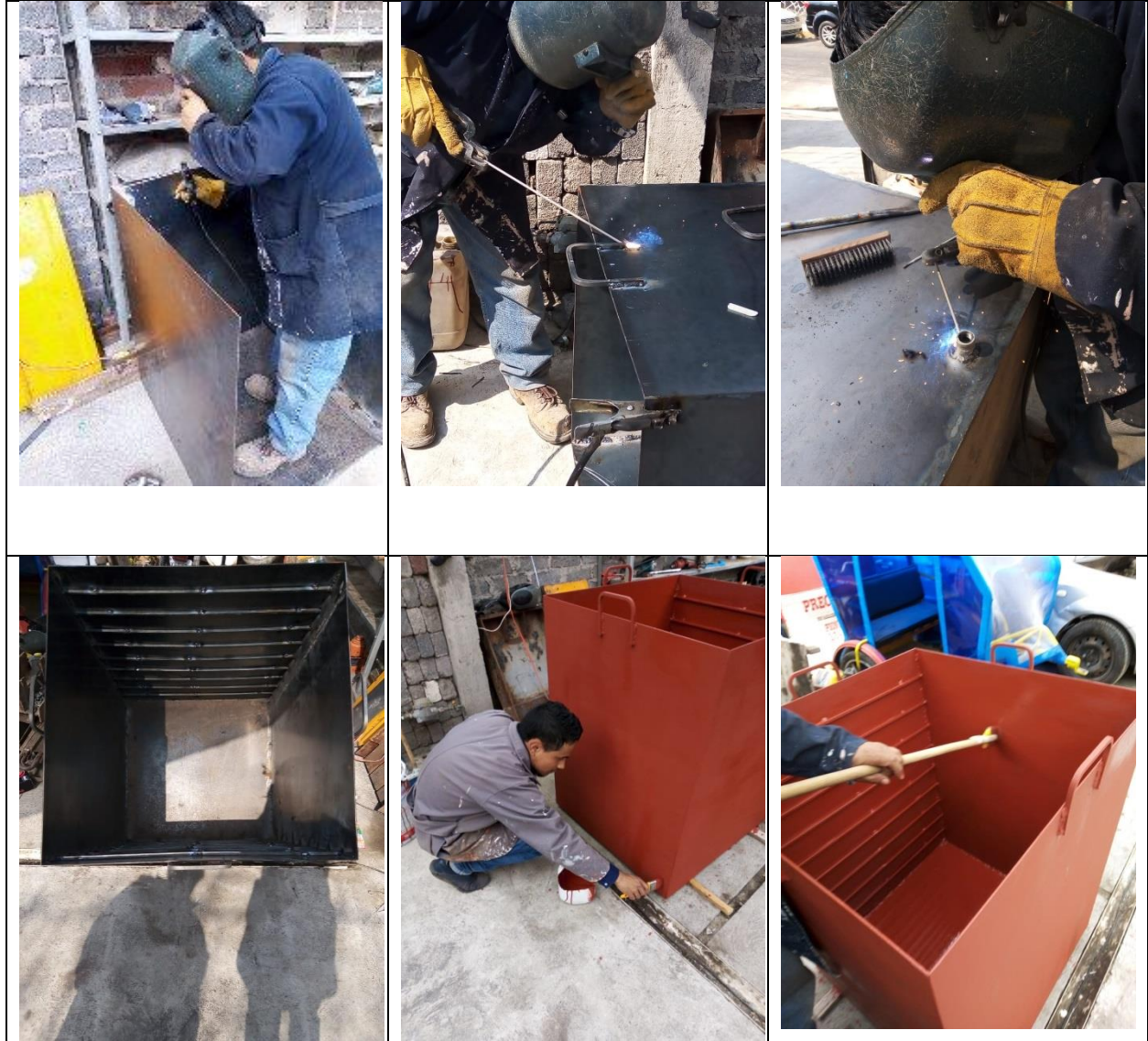
Figura 31. Proceso de fabricación del contenedor para pilotes W24x55.
