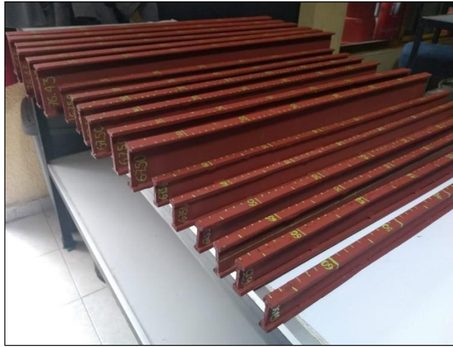
Figura 29. Fotografía de los 18 pilotes a escala tipo IR pintados con pintura anticorrosiva y marcados a cada 1 cm para llevar un registro del número de golpes con la profundidad.
