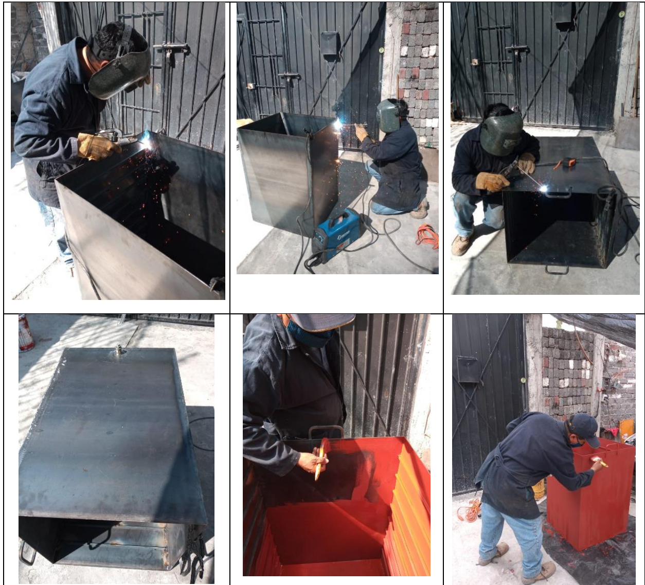
Figura 32. Proceso de fabricación del contenedor para pilotes W18x35.
