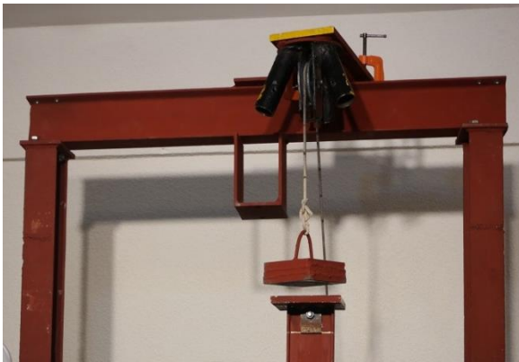
Figura 39. Sistema de hincado del contenedor 24X55.
