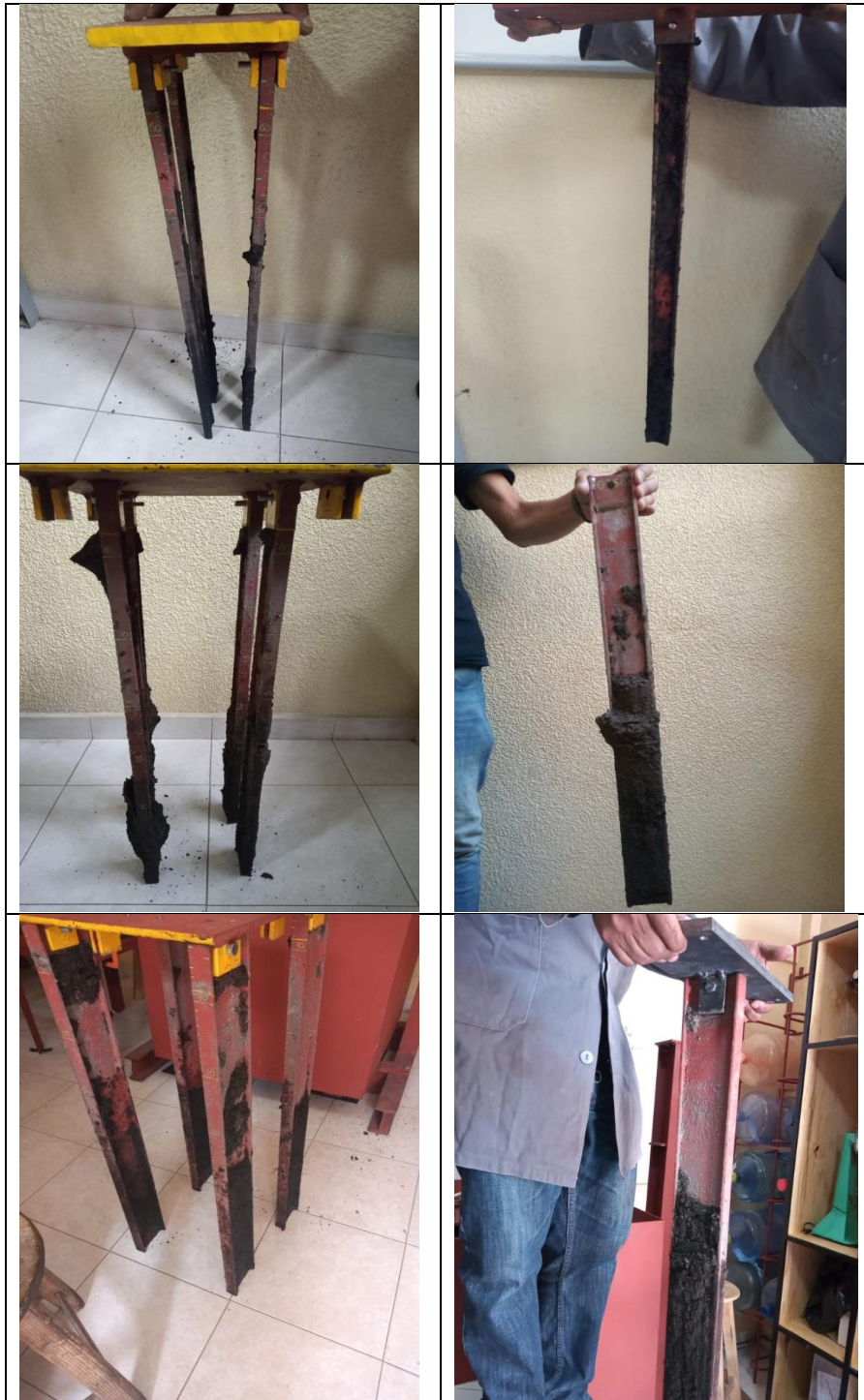
Figura 65. Fotografías de suelo adherido al pilote al extraerlo después de la prueba de carga a tensión.
