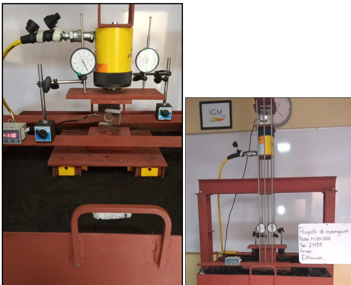
Figura 50. Prueba de compresión y tensión axial.
